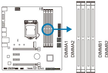
步骤1: 向外推开固定夹, 打开DIMM插槽。将DIMM按顺序放在插槽上, DIMM上的缺口须与插槽凹口匹配。
