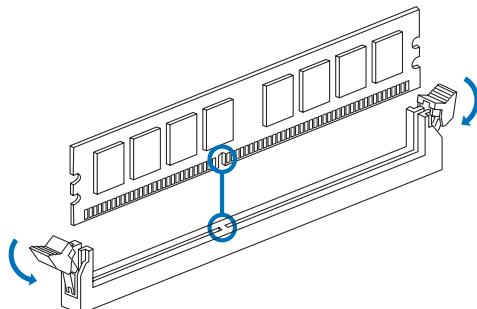
步骤2: 垂直插入DIMM并固定好, 直到固定夹跳回原位, DIMM就位。
