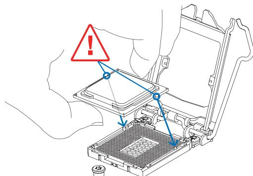
步骤5: 固定CPU, 将拉杆闭合。
