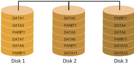
RAID 5数据块和奇偶块信息跨3块或更多块驱动器。奇偶校验数据分散分布在磁盘阵列的全部硬盘。容错的维护是由确保数据块传输奇偶块信息实现的，此信息被放置在不同于那些自身可以储存信息的驱动盘里。
