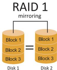
每次读写实际上是在磁盘阵列系统中(RAID 1)，通过2个磁盘驱动器并行完成的。RAID 1或镜像模式能够自动对数据进行备份，通过将一块硬盘中的数据完整复制到另外一块硬盘实现数据的冗余。假如由于硬盘的损坏，导致驱动失败，或是容量过大，RAID1可以提供一份数据备份。RAID 技术可以应用于高效方案，或者可以作为自动备份形式，代替冗长的，高价的且不稳定的备份形式。
