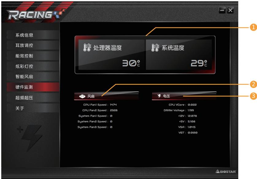
1. 处理器温度/系统温度：显示当前CPU和系统温度。
