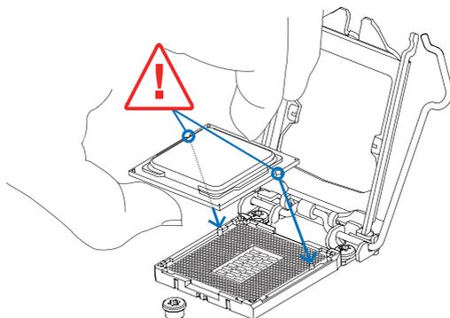
步骤5: 固定CPU，将拉杆闭合。
