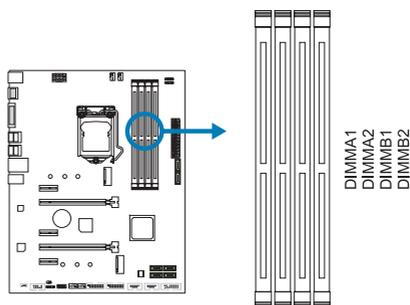
步骤1: 向外推开固定夹，打开DIMM插槽。 步骤2: 垂直插入DIMM并固定好，直到固定夹跳回原位，DIMM就位。
