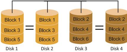
RAID 10模式是对RAID 0/ RAID 1两种不同模式的结合，可以同时支持带区集和镜像，这样既可以提升速度又可以加强数据的安全性。
