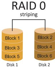
创建带区集，在同一时间内向多块磁盘写入数据，通过把数据分成多个数据块（Block）并行写入/读出多个磁盘以提高访问磁盘的速度分散到所有的硬盘中同时进行读写，在整个磁盘阵列建立过程中，以系统环境为基础，指数的大小决定了每块磁盘的容量。此技术可减少整个磁盘的存取时间和提供高速带宽。
