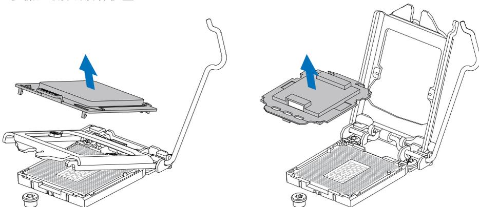
步骤4: 按照箭头的指示方向，将CPU上的切口对准插槽上相应的位置，然后将CPU放入插槽处
