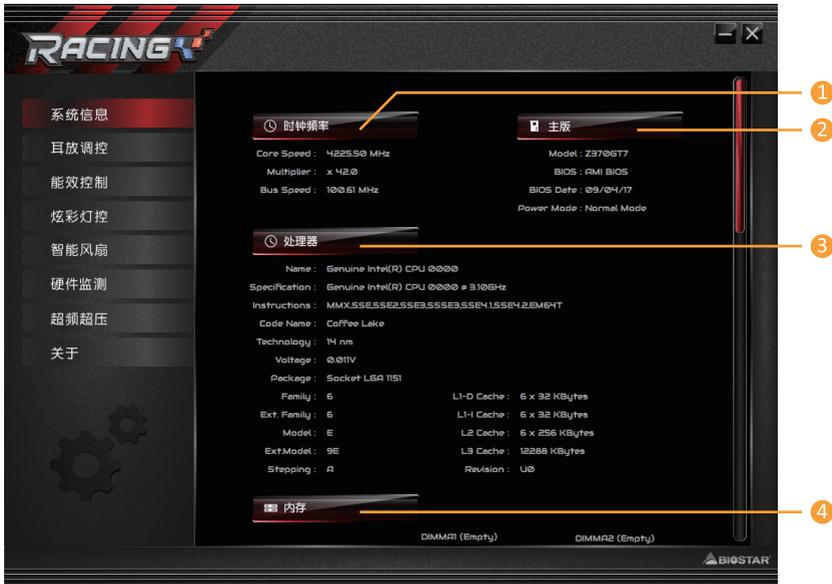
1. 时钟频率：显示核心频率，倍频和总线速度。
