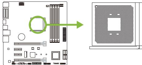
步骤2: 将固定拉杆从插槽处水平拉起至90度。
