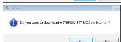
6. 完成下载后，屏幕弹出提示您刷新BIOS的对话框，点击“Yes”开始刷新。
