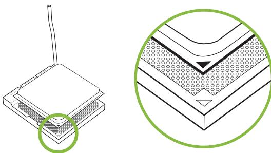
步骤4: 固定CPU，将拉杆闭合。
