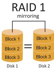
每次读写实际上是在磁盘阵列系统中(RAID 1) · 通过2个磁盘驱动器并行完成的。RAID 1或镜像模式能够自动对数据进行备份 · 通过将一块硬盘中的数据完整复制到另外一块硬盘实现数据的冗余。假如由于硬盘的损坏 · 导致驱动失败 · 或是容量过大 · RAID1可以提供一个数据备份。RAID 技术可以应用于高效方案 · 或者可以作为自动备份形式 · 代替冗长的 · 高价的且不稳定的备份形式。
