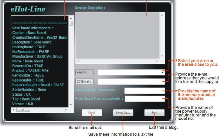
填好表格信息后，点击“Send”发送邮件。将出现一个确认信息对话框；点击“Send”确认发送点击“Do Not Send”则取消操作。
