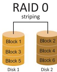
创建带区集，在同一时间内向多块磁盘写入数据，通过把数据分成多个数据块（Block）并行写入/读出多个磁盘以提高访问磁盘的速度分散到所有的硬盘中同时进行读写，在整个磁盘阵列建立过程中，以系统环境为基础，指数的大小决定了每块磁盘的容量。此技术可减少整个磁盘的存取时间和提供高速带宽。
