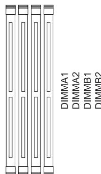
步骤1: 向外推开固定夹, 打开DIMM插槽。将DIMM按顺序放在插槽上, DIMM上的缺口须与插槽凹口匹配。
