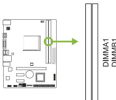
步骤1: 向外推开固定夹, 打开DIMM插槽。将DIMM按顺序放在插槽上, DIMM上的缺口须与插槽凹口匹配。
