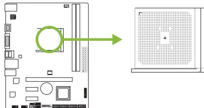
步骤2: 将固定拉杆从插槽处水平拉起至90度。
