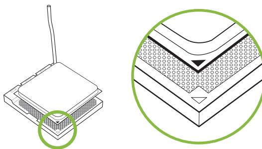
步骤4: 固定CPU，将拉杆闭合。
