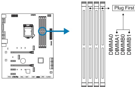
步驟1: 向外按壓固定夾以解鎖DIMM插槽。對準插槽上的DIMM，以使DIMM上的槽口與插槽上的缺口符合。
