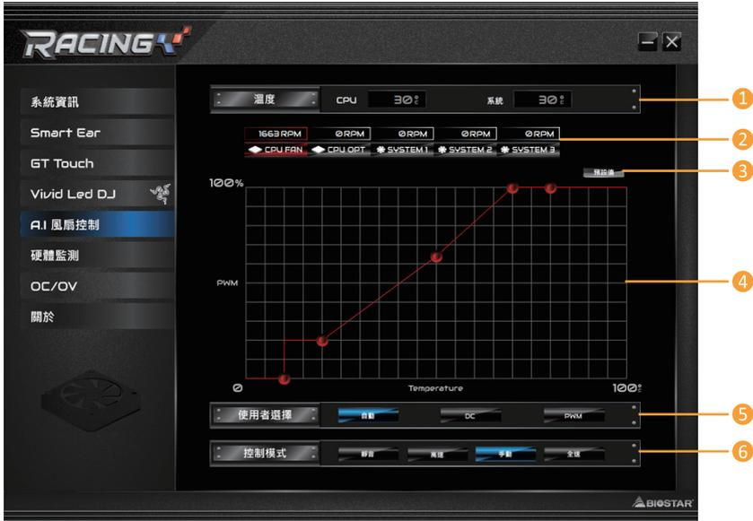
1. 溫度：顯示當前CPU和系統溫度。
