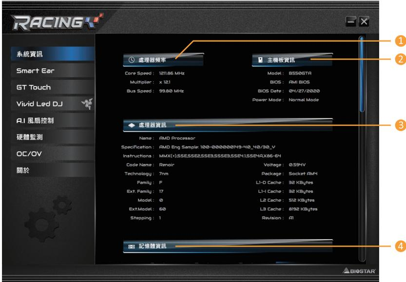
1. 處理器頻率：顯示核心頻率、倍頻和匯流排速度。
