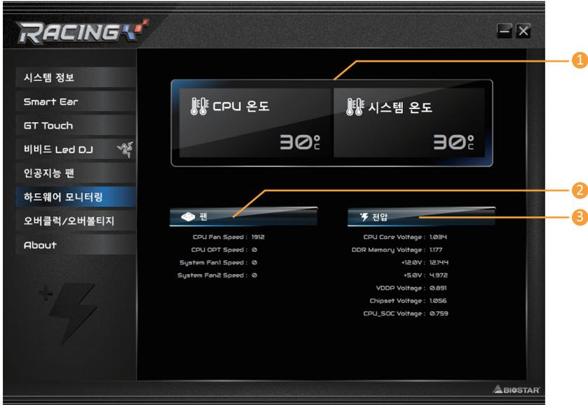
1. CPU 온도/시스템 온도: 현재 CPU와 시스템 온도 표시.
