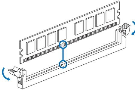
步驟2: 垂直將DIMM牢固地插入插槽，直到固定夾扣跳回原位，並且DIMM正確就位。
