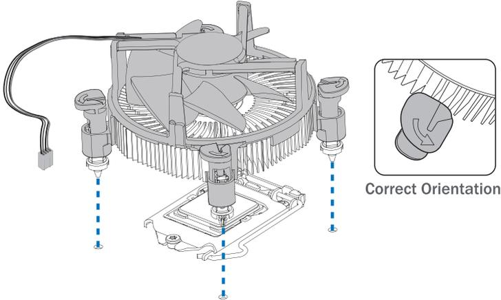
步驟2: 依序把對角2個固定件同時向下按壓，以固定風扇，完成CPU安裝。
